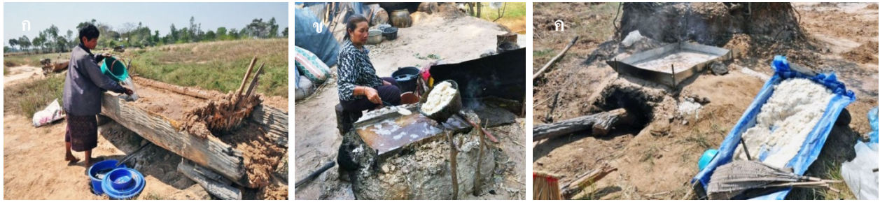
รูปที่ 1 3,4) ก). เทน้ำสะอาดใส่ดินเือกที่บรรจุอยู่ในรางกระอะน้ำเกลือ ด้านล่างของรางกระอะมีรูให้น้ำเกลือไหลผ่านมาสะสมในภาชนะรองรับ ข). การตม่น้ำเกลือหรือน้ำเือกจนได้เป็นเกลือสินเธาว์ ค). หลังจากเคี้ยวหุงน้ำเือกได้เป็นเกลือแล้วจะนำมาผึ่งให้แห้ง
